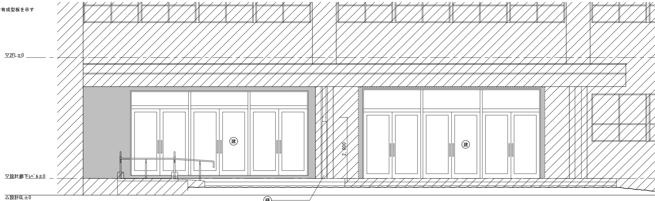
KBM+2,000でカッター切り 縦樋VPφ100撤去 養生管GPφ125 L=1,800 【現況・撤去】北立面図 1/50
