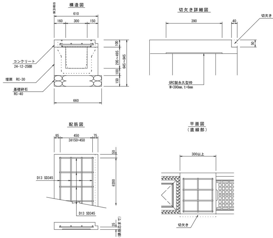
PU横断側溝取り合い部（参考図）みぞ幅300の場合
