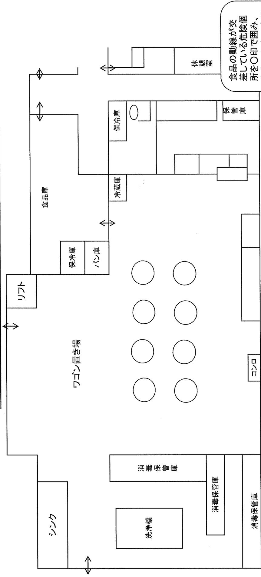
食品の動線が交差している危険箇所を○印で囲み、作業工程表で時間差があることを示す。
